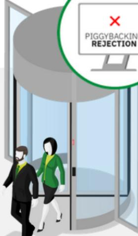
**2** Ein Rücksignal wird an das ACS gesendet, um eine "Huckepack-Zurückweisung" zu protokollieren.
