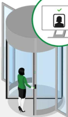
**2** Die Anmeldeinformationsdaten werden vom Lese-gerät an der Tür zum Access Control System (ACS) an einem Remotestandort oder in der Cloud übertragen, wodurch überprüft wird, ob sich die Anmeldeinformationen des Benutzers im System befinden.
