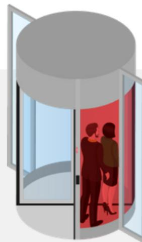
**1** Wenn zwei Personen gleichzeitig versuchen, in dasselbe Fach einzutreten (Huckepack), werden sie vom Overhead-Sensorsystem zurückgewiesen, sodass beide Benutzer auf der nicht sicheren Seite aussteigen müssen.
