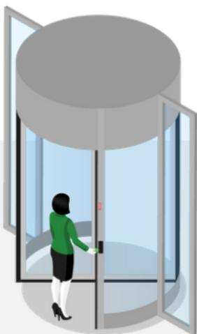
**1** Ein Benutzer nähert sich der Sicherheits-Drehtür an einem Eingang nur für Mitarbeiter und legt seinen Berechtigungsnachweis auf das Lesegerät für die Zugangskontrolle (Zugangskarte, PIN, QR-Code, Biometrie usw.).
