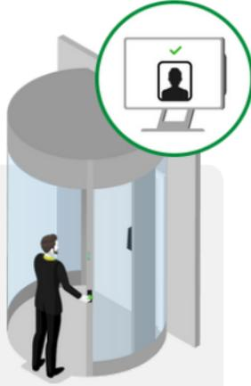
**2** Die Anmeldeinformationen werden vom Lesegerät an der Tür zum Access Control System (ACS) an einem Remote-standort oder in der Cloud übertragen, wodurch überprüft wird, ob sich die Anmeldeinformationen des Benutzers im System befinden.
