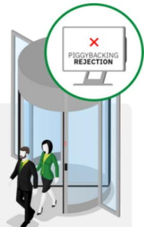
**3** Ein Rücksignal wird an das ACS gesendet, um eine "Huckepack-Zurückweisung" zu protokollieren.
