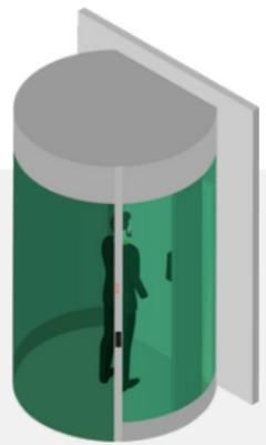
**3** Nach der Autorisierung öffnet sich die erste Tür des Portals und der Benutzer tritt ein. Nach dem Schließen der ersten Tür scannt ein Overhead-Sensorsystem das Fach, um sicherzustellen, dass der Benutzer alleine ist.
